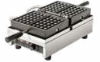
746 Gaufrier simple électrique 220 V / 16A monophasé - 1 800 W. Thermostat réglable de 50 à 300°C. Témoin de chauffe, s'éteint lorsque la température est atteinte. Dimensions : 44 x 26 x 22 cm - 2 plateaux récupérateurs de résidus de cuisson - Taille de l'empreinte : 182 x 113 x 28 mm - 20 Kg.
