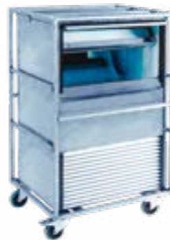
27089 Machine à glaçons Int. : L 67 x P 56 cm H 98 cm Ext. : L 72 x P 66 cm H 116 cm Porte glissant vers l'intérieur - 775W 30 mn de mise en marche et refroidissement Cycle de 15 mn = 55 glaçons Production de 75 Kg /24h Stockage 37 Kg - Poids 60 Kg En complément : pelle à glaçons page 219
