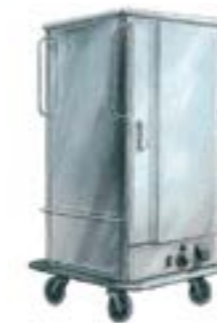
411 Etuve ventilée humidifiée 8 grilles 220 V / 16A monophasé - 2,2 kW. Température maxi : 150 °C en 50 min. Livrée avec 8 grilles gn 2/1 (65 x 53 cm). Espace entre les grilles : 10,5 cm. Bloc de ventilation surmonté d'un bac gn 2/1 et d'un Z antivague. Ext. : L 77 ; I 93 ; H 162 cm. 135 Kg
