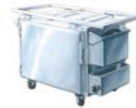
11527 Etuve électrique petit modèle 220/230 V - 16 A monophasé - 2 kW Température maxi 150°C en 30 min - Combiné adaptable pâtisserie ou gastronome 1/1. Fourni avec 5 grilles pâtisseries 60 x 40 cm. Espace entre les grilles : 7 cm. Ext. : L 89 ; P 50,5 ; H 73 cm. Int. : L 60 ; P 40 ; H 45,5 cm
