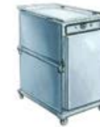
9938 Etuve électrique ventilée 8 grilles Electrique 220 V / 16A monophasé 3 kW. 1 prise. Température maxi : 250°C en 60 min. Livrée avec 8 grilles pâtisseries 60 x 40 cm. Espace entre les grilles : 7 cm. Ext. : L 65 ; I 105 ; H 132 cm. Int. : L 40,5 x I 60 x H 85,5 cm 150 Kg
