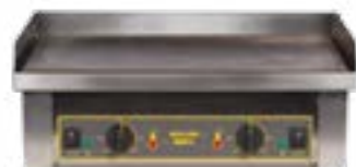
7021 Plaque à cuire acier 60 x 40 cm 220 V - 3500 W 2 zones de chauffe Thermostat de 0° à 300° Dim. : L 62 x P 44 x H 24 cm Poids : 33 kg Conditionnement : bac en plastique : L 80 x P 60 x H 32 cm
