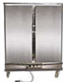
27496 Armoire chauffante 40 GN 1/1 220 V - 2250 W 10 rails de guidage espacés de 10 cm Fourni avec 10 grilles GN 2/1 Thermostat de 0° à 90° Capacité : 400 assiettes empilées Dim. intérieures : 2 x (L 52,5 x P 65 x H 125 cm) Poids : 213,4 kg Conditionnement : chariot fixé : L 113 x P 84 x H 175 cm
