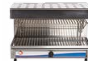
26229 Salamandre au gaz Fournie avec 1 grille (L 80 x P 34 cm) réglable en hauteur Consommation gaz maximum 0,6 kg/h Détendeur mâle type POL, longueur du tuyau : 2 m Dim. : L 80 x P 45 x H 58 cm Poids : 33 kg Conditionnement : caisson en bois : L 96 x P 55 x H 75 cm Possibilité de louer la bonbonne de gaz p.135
