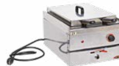
6514 Cueilleur à pâtes (3 paniers) 220 V - 3250 W Thermostat de 1 à 10 Capacité : 2 paniers de 200 g et 1 panier de 400 gr (4 à 5 L d'eau max) Idéal pour remise en température de pâtes précuites Dim. : L 38 x P 50 x H 30 cm Poids : 18,8 kg Conditionnement : bac en plastique : L 70 x P 47 x H 37 cm
