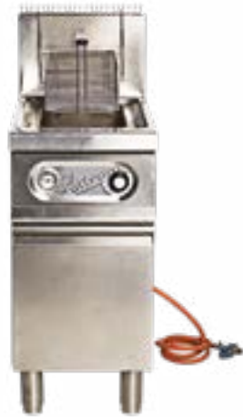
26241 Friteuse au gaz sur pied 1 x 20 L Détendeur mâle type POL - longueur du tuyau : 2 m Thermostat de 70° à 190° Dim. : L 40 x P 70 x H 112 cm Poids : 95,4 kg Possibilité de louer la bonbonne de gaz p.135 Prévoir 15 L d'huile
